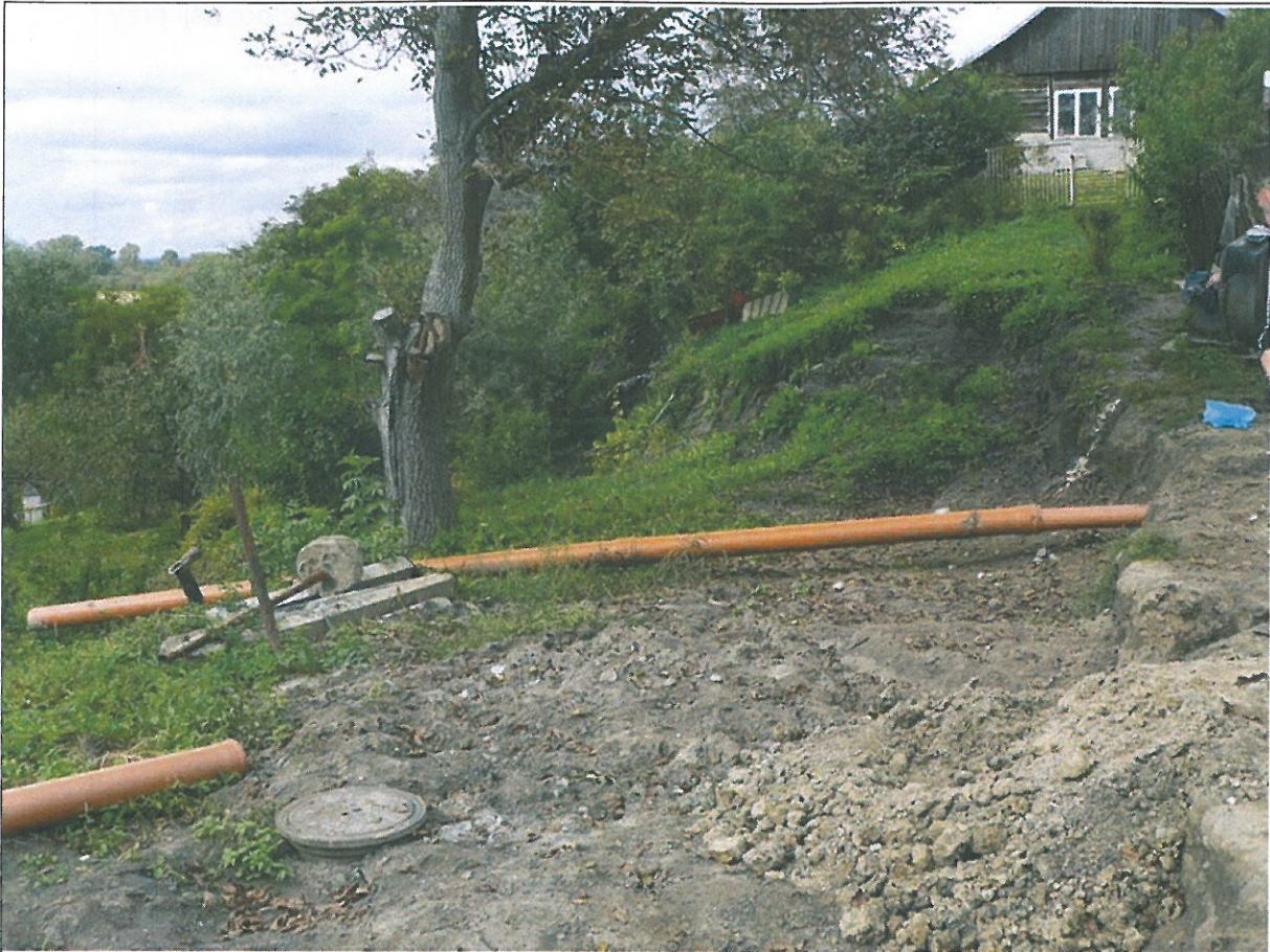
Fot. 1. Świeża skarpa główna osuwiska odsłaniająca rury kanalizacyjne w obrębie koluwium na terenie posesji przy ul. A. Mickiewicza 116A.
